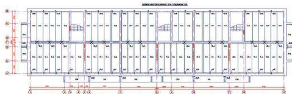
Рис.2 План перекрытия 4-этажного жилого дома
