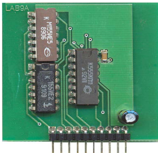
11.41-rasm. Schetchiklar ishini tadqiq etishda qo'llaniladigan Lab9A modulining tashqi ko'rinishi.
