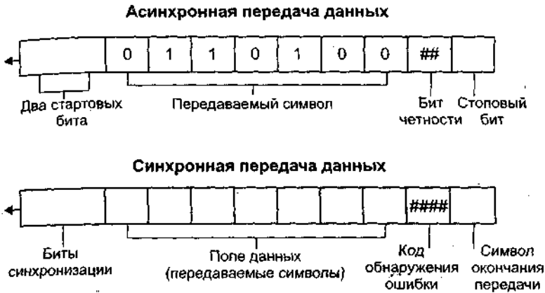
Рис. 2.2. Асинхронная и синхронная передача данных
