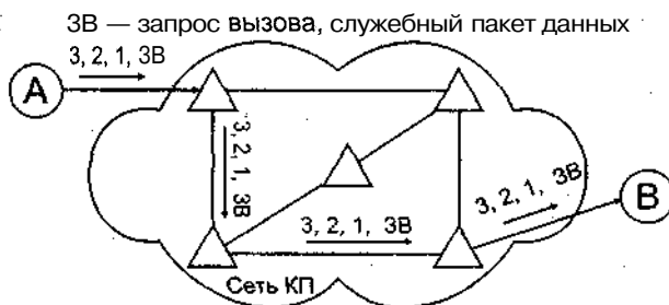
Рис. 1.9. Виртуальный метод передачи
