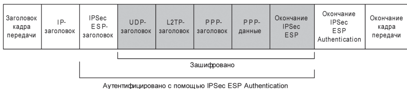
Рис. 8.8. Структура пакета для пересылки по туннелю L2TP
