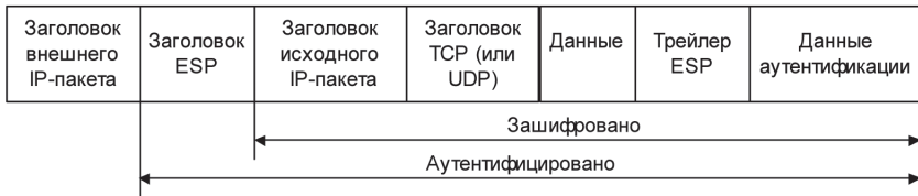
Рис. 9.6. IP-пакет после применения протокола ESP в транспортном и туннельном режимах
