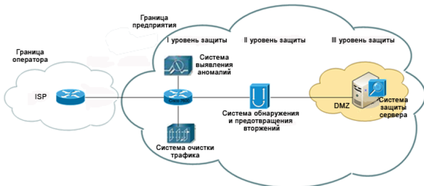
Рис. 13.3. Схема защиты предприятий от DDoS-атак
