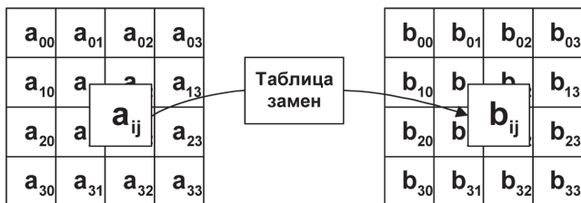
Рис. 6.9. Преобразование BS (ByteSub) использует таблицу замен (подстановок) для обработки каждого байта массива State
