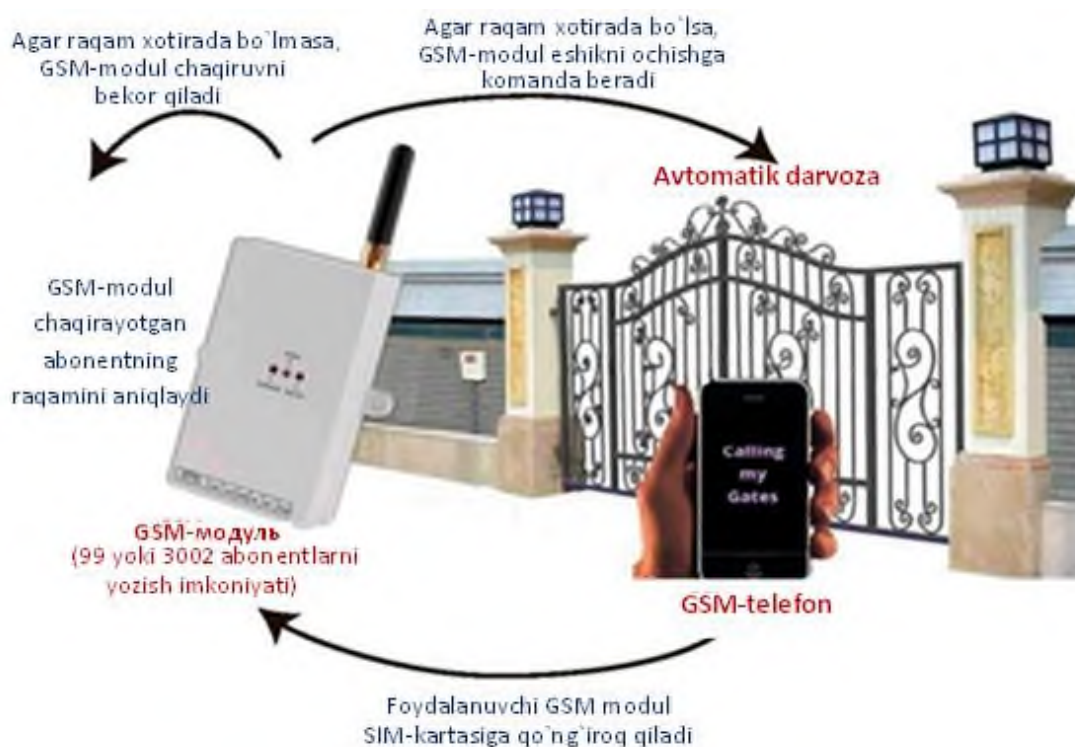
6.1- rasm. Darvozalarni ochish qurilmasinin ishlash tamoyili
